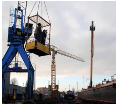
Abb. 6: Mobile Vermessung des gesamten Schiffsrumpfes mit dem TRITOP CMM System.
