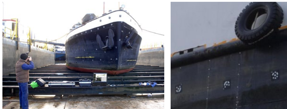
Abb. 2: Das mobile optische TRITOP CMM System im Einsatz vor Ort. System und Zubehör können problemlos von einer Person transportiert werden. Eine externe Stromversorgung ist weder für die Messung noch für die anschließende Auswertung nötig.
