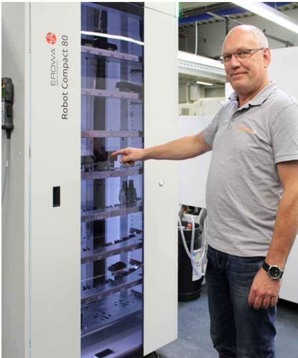
Abb. 3: Ralf Runte, Group Leader Mechanical Processing Tooling bei Weidmüller: „Wir haben einen EROWA-Roboter ERC 80 mit einer ATOS ScanBox Serie 4 von GOM zu einer Automatisierungslösung vereint.“
