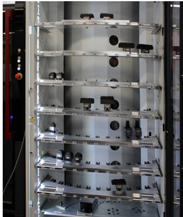
Abb. 4: Bis zu 120 Elektroden finden in dem Magazin der Anlage Platz
