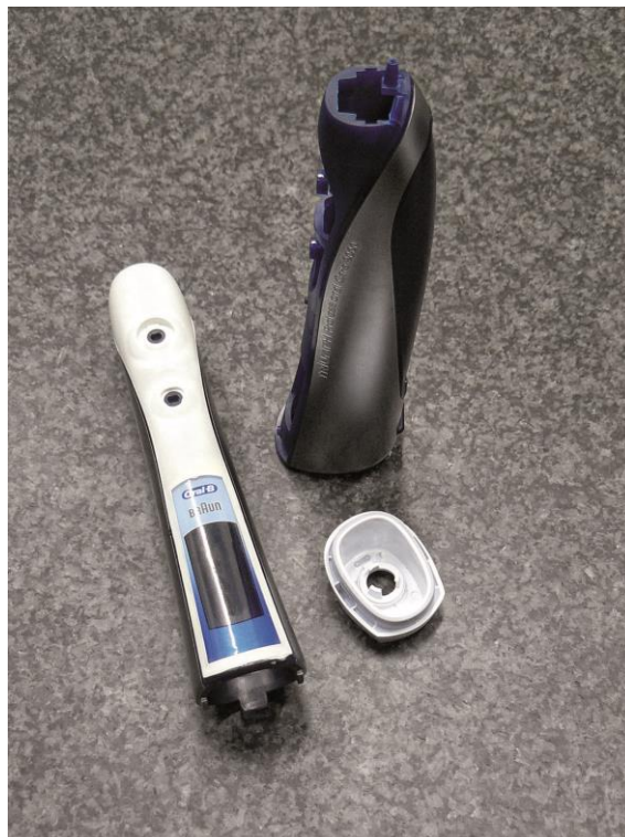
Abb. 3: Speziell bei diesem Gehäuse verändern sich durch das mechanische Spannen und Galvanisieren die Geometrien; zudem existiert eine echte 3D-Dichtung. Ein taktilen Vermessen war in der Vergangenheit deshalb nahezu unmöglich.
