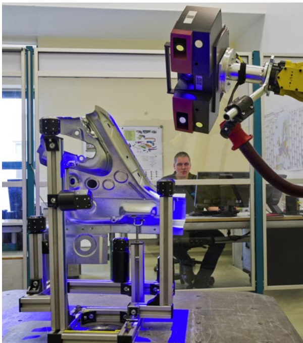
Fig. 4 : Cellule de mesure personnalisée avec équipement GOM, première solution automatisée de GEDIA.
