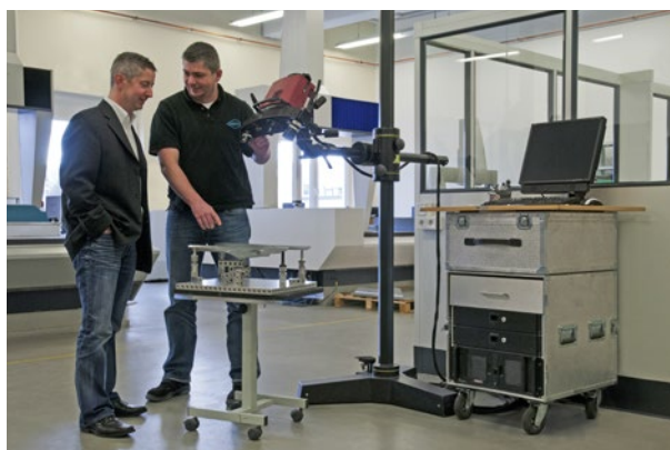
Fig. 2 : GEDIA a choisi d'amorcer sa transition en investissant dans un scanner 3D ATOS permettant une métrologie pleine surface sans contact des coordonnées 3D. Les données de mesure peuvent être analysées instantanément et comparées directement aux données CAO. Les écarts par rapport à la CAO sont mis en évidence à l'aide de couleurs. Les zones problématiques sont ainsi facilement identifiables, ce qui permet d'améliorer précisément le processus de fabrication.
