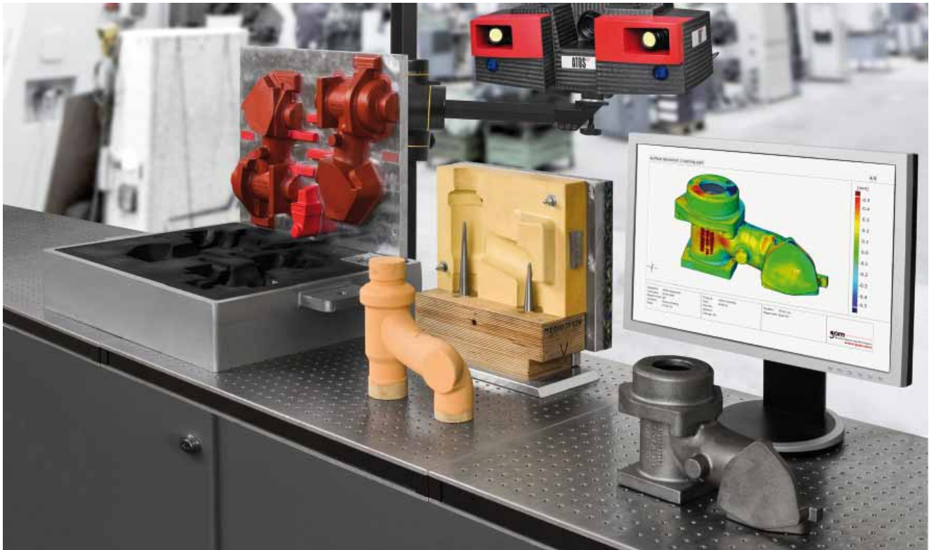
Bild 3: Die optische Messtechnik unterstützt und beschleunigt fast alle Bereiche vom Modell- und Werkzeugbau, über die Formerei/Kernmacherei bis hin zum Erstmusterbericht und der Optimierung der CNC-Bearbeitung
