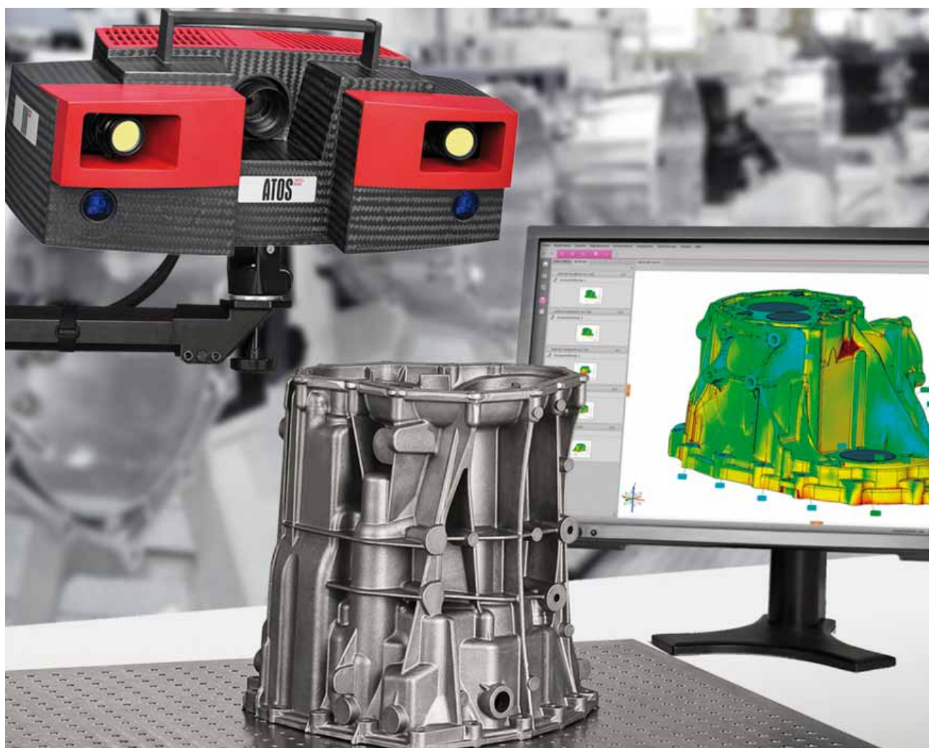
Bild 1: Atos Triple Scan 3-D-Koordinatenmesssystem für die vollflächige Bauteilvermessung.
