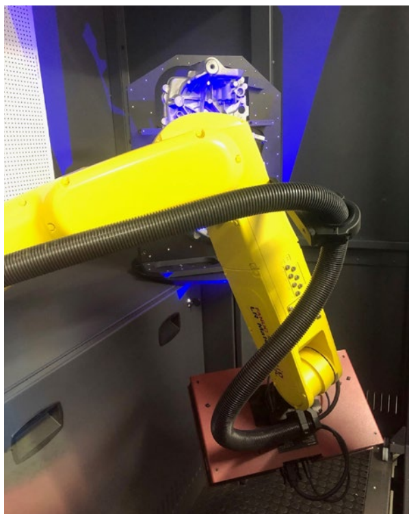
Mesure d'un couvercle (Image: GOM)
