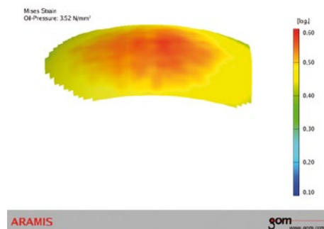
Abb. 13: Form der Blechprobe mit Darstellung der Vergleichsformänderung nach von Mises
