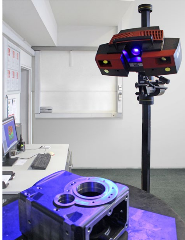
Abb. 6: Die Projektionseinheit des ATOS Triple Scan Systems basiert auf der Blue Light Technology. Der Sensor arbeitet mit schmalbandigem blauen Licht, sodass störendes Umgebungslicht bei der Bildaufnahme ausgefiltert werden kann.
