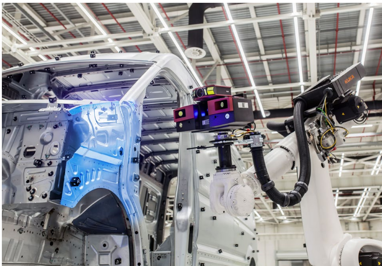
Fig. 3 : Contrôle plein-champ des composants de caisse en blanc avec l'ATOS TripleScan
