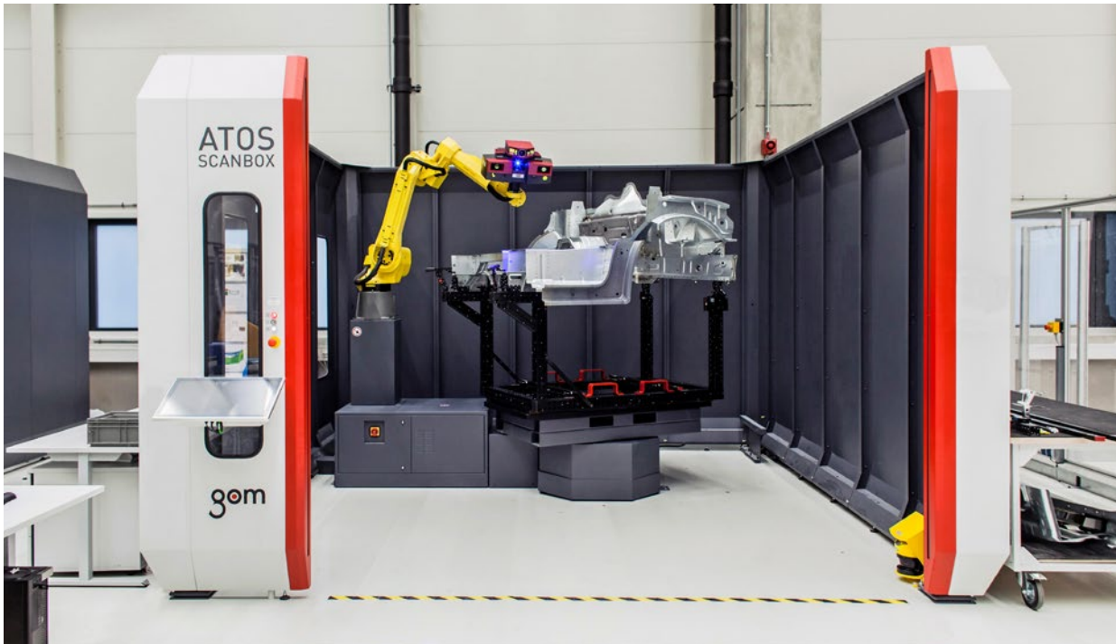
Fig. 4 : Inspection du bas de caisse dans l'ATOS ScanBox Series 6
