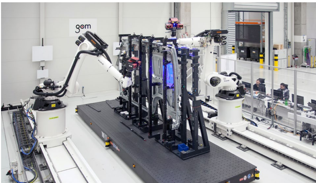
Fig. 1 : Hall de mesure sans contact connecté au centre de cubing et à la ligne de construction de la carrosserie
