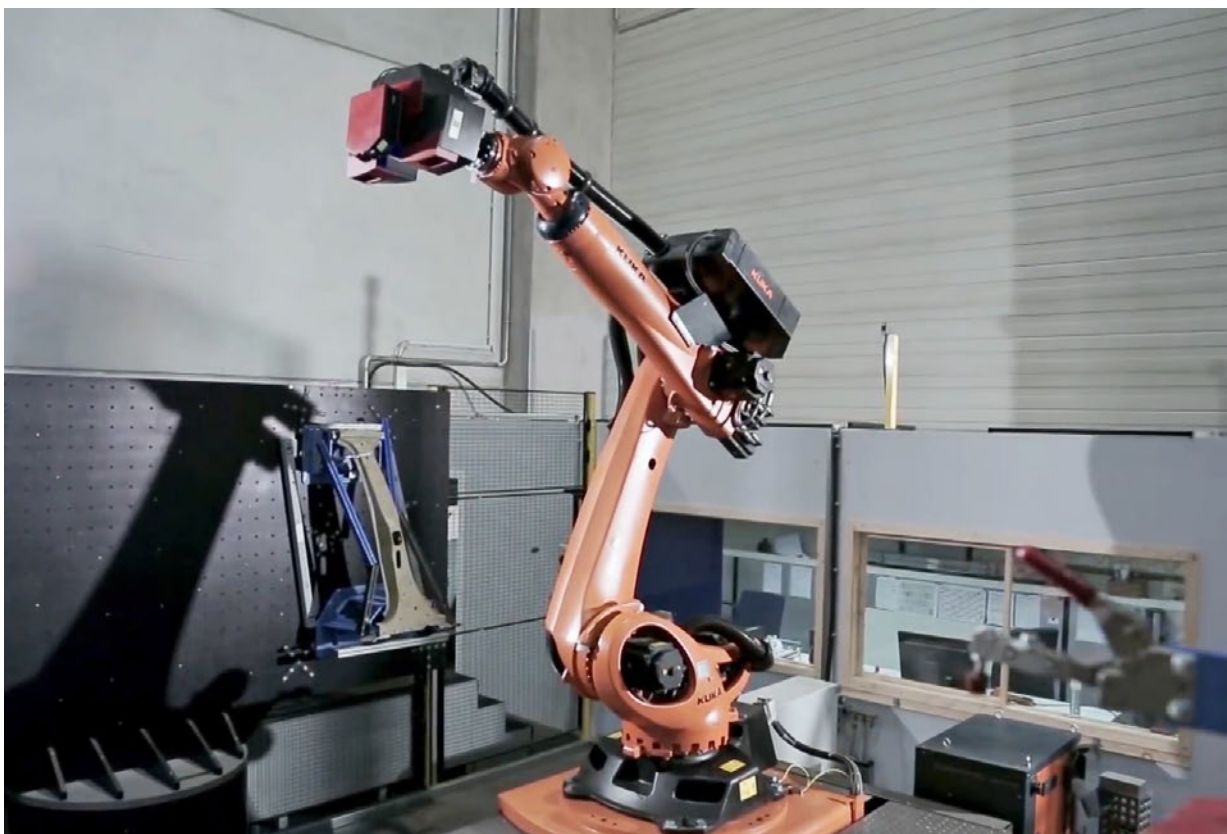
Fig. 2 : Le scanner 3D ATOS Triple Scan peut être utilisé comme système automatique ou manuel. Le robot peut rapidement être transformé en support mobile.
