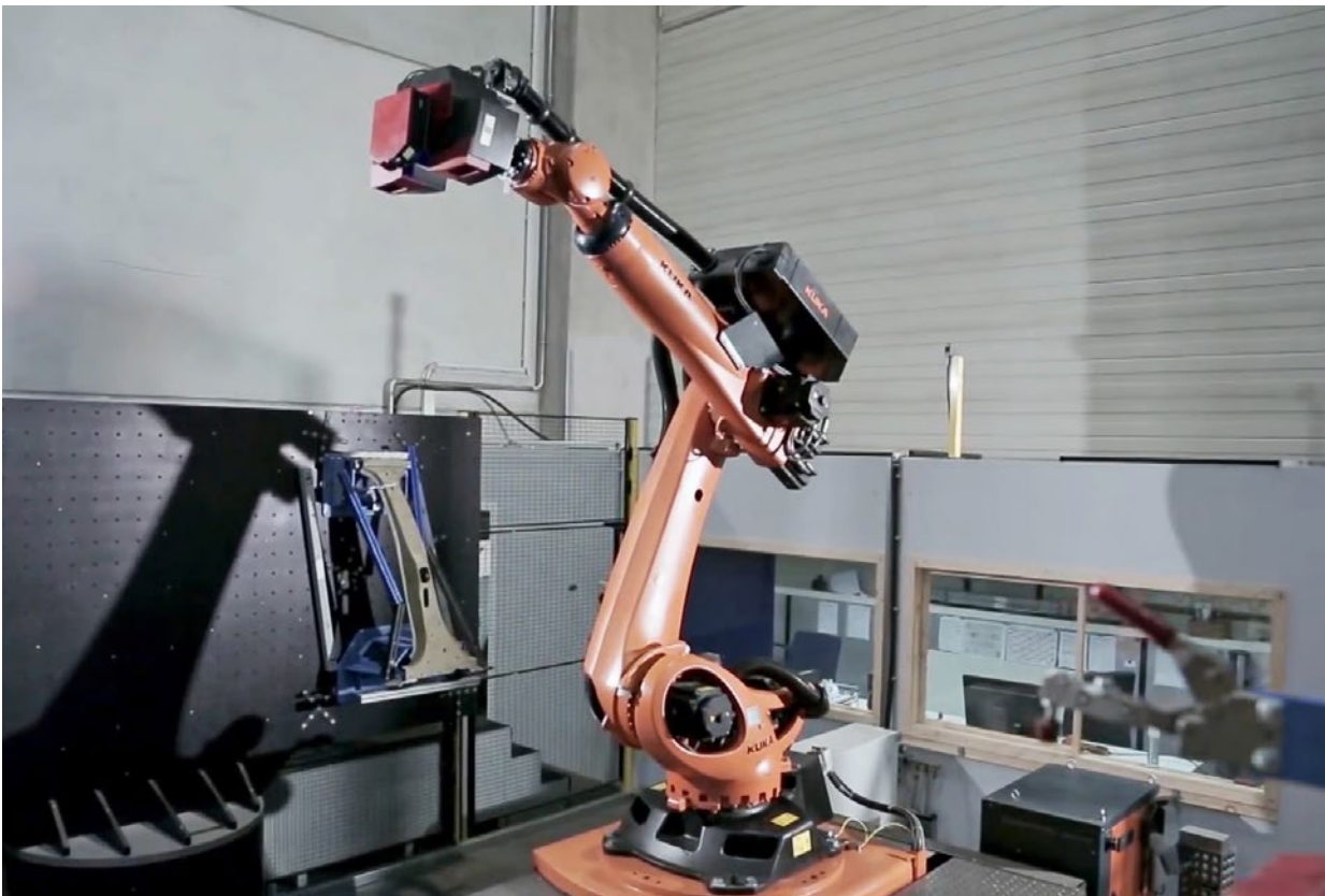
Abb. 2: Der 3D-Digitalisierer ATOS Triple Scan kann sowohl automatisiert als auch manuell eingesetzt werden. Die Umbauzeit von Roboter auf ein mobiles Stativ ist in kurzer Zeit realisierbar.
