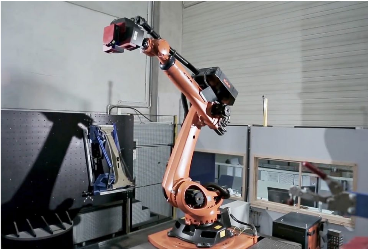
图2：ATOS Triple Scan三维扫描仪既可作为自动化系统使用，也支持手动方式操作。从机器人调整到移动式支架，操作方便迅速。
