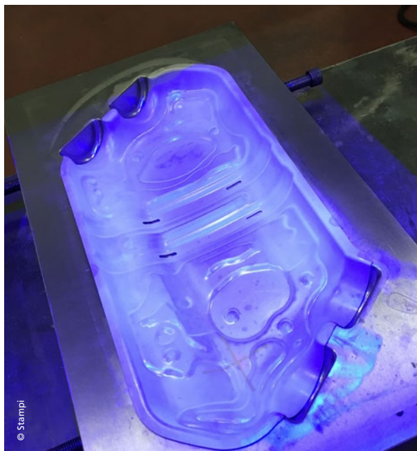
Uno stampo P&C Automotive durante la fase di scansione
