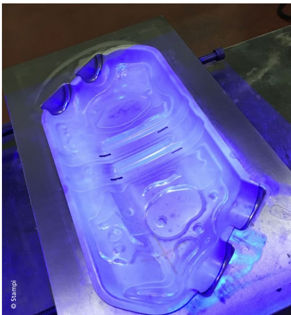
Mesure d'un outil d'emboutissage à l'aide du système ATOS (Blue Light Technology)
