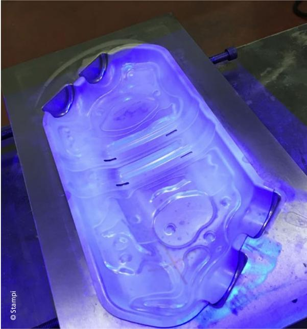
使用 ATOS（蓝光技术）测量成型工具
