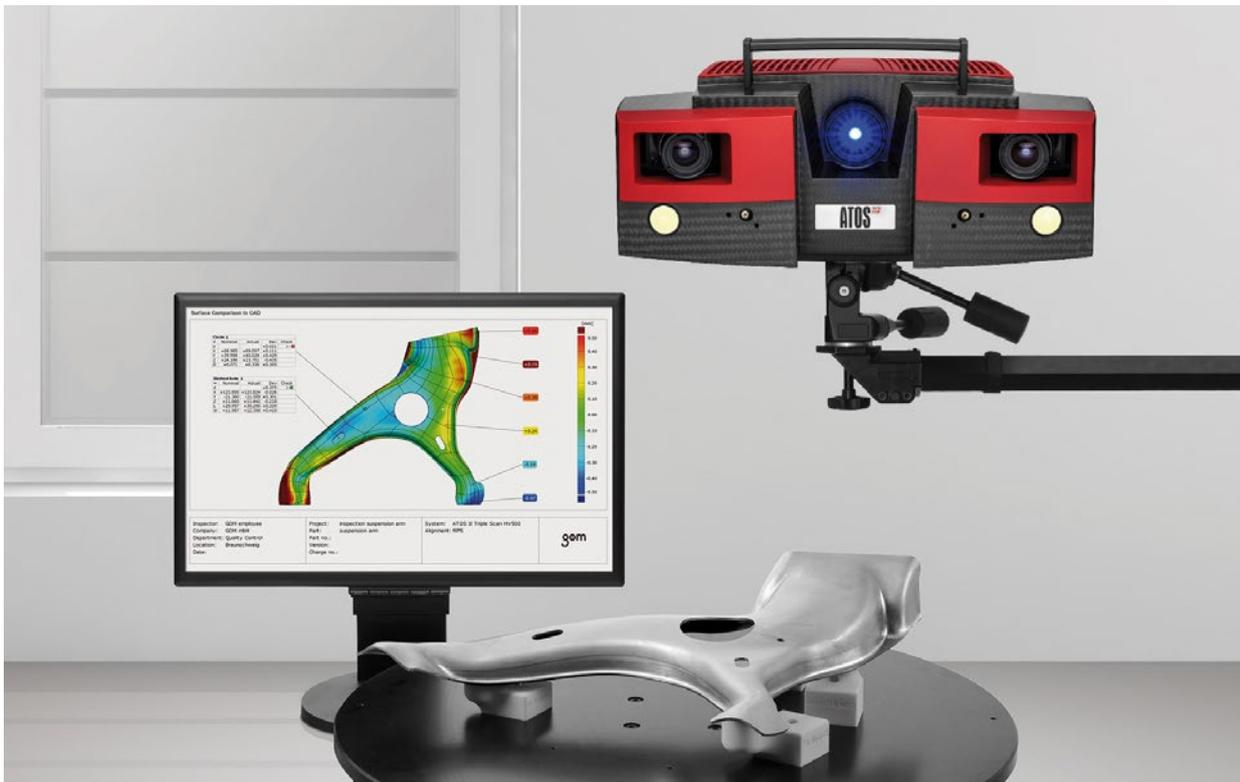
使用 ATOS Triple Scan 检验钣金件，并生成检测报告
