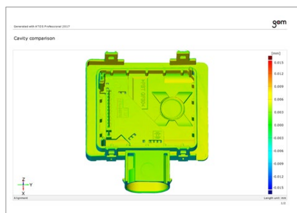
Messberichterstellung in der GOM Inspect Professional Software: Kavitätenvergleich als farbige Abweichungsdarstellung
