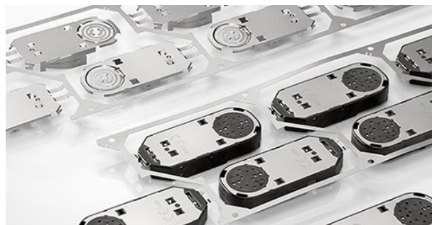
Fertigung von Kassettengehäusen für Blutzuckermessgeräte
