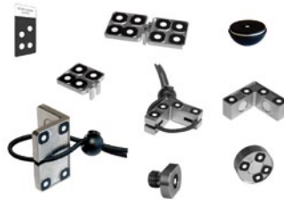
Abb. 5: GOM Adapter zur Messung von Geometrie-elementen
