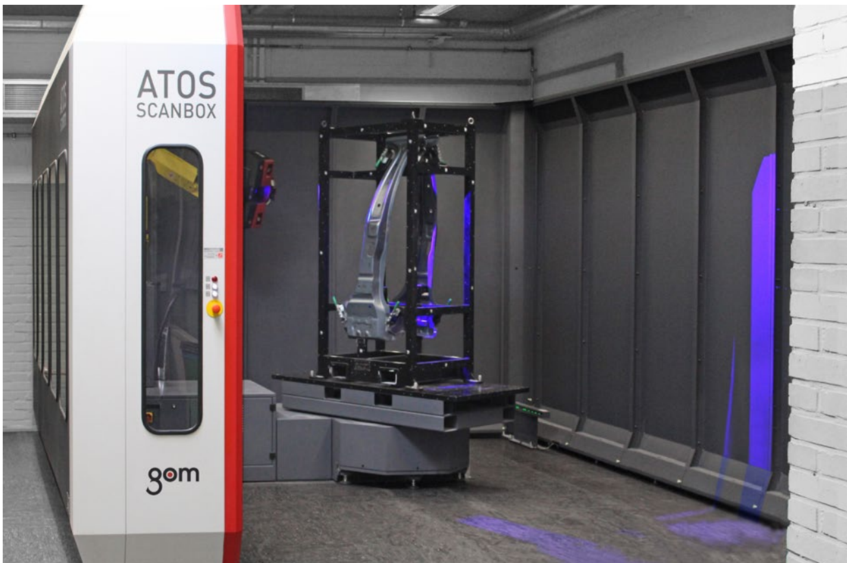
Abb. 1: Der ATOS Triple Scan Sensor – Kern der ATOS ScanBox bei Metalsa – ermöglicht die präzise Messung von reflektierenden Blechteilen sowie scharfkantigen Merkmalen wie Laserbeschnitt und Lochbild.
