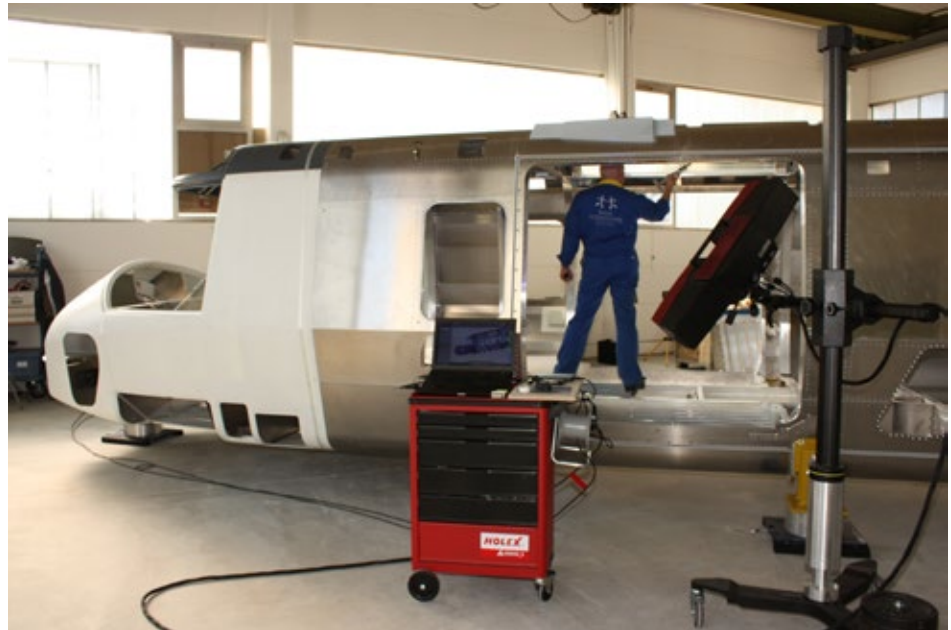
Abb. 3: Bei der Endmontage der Schulungsgeräte findet eine erneute 3D-Vermessung mit dem ATOS Triple Scan statt. Dabei wird auch die korrekte Positionierung der Einzelteile mittels optisch getracktem Taster punktuell geprüft.
