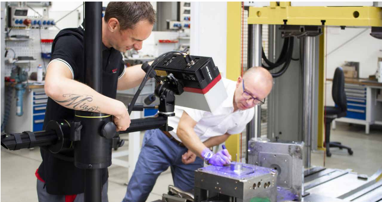
Abb. 1: Der ATOS Capsule kommt zur Überprüfung der Werkzeugeinsätze direkt in der Produktion zum Einsatz. Im Bild: Geschäftsführer Ulrich Seifferth und Mitarbeiter Maik Muschko
