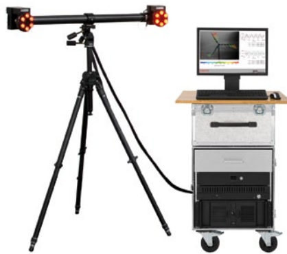
Abb. 1: PONTOS System zur optischen dynamischen 3D-Analyse, Sensor, Stativ, Kalibrierkreuz, Rechner, (typischer Messaufbau)
