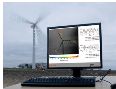
Abb. 4: Online-Verformungsmessung einer Windkraftanlage. Das PONTOS-System ermöglicht die Analyse von Vibrationen, Frequenzen, Verdrehung, Durchbiegung, Geschwindigkeit, Beschleunigung, sowie von Bewegungsbahnen
