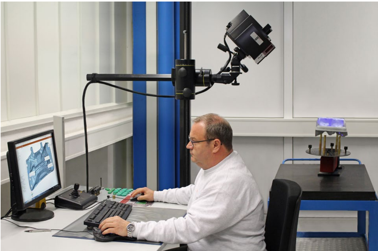
Abb. 2: Wilfried Braun, Messtechniker bei PWO, bei der Toleranzprüfung eines Motorträgers.
