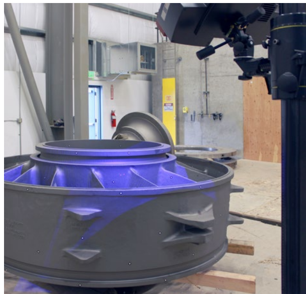
图3：蓝光技术。投影装置的细条蓝光使扫描仪在扫描过程中免受外界光线的影响；对于反光表面，蓝光技术扫描效果更佳。
