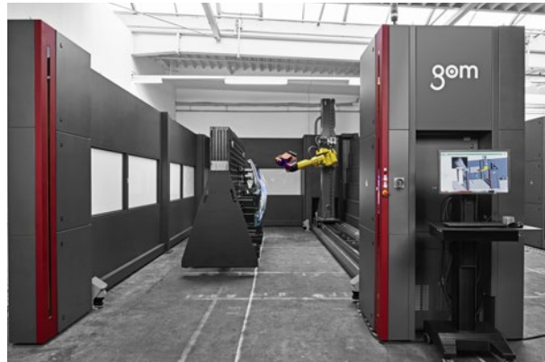
ATOS ScanBox 7260 – optische 3D-Koordinatenmessmaschine für große Bauteile
