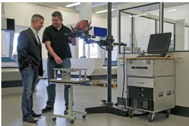
图 2：通过投资可移动式 ATOS 三维扫描仪这一全场表面光学三维坐标测量系统，吉地亚公司 (GEDIA) 得以实现从触觉测量到光学测量的转变。既可立即比较测得的测量数据，还可直接将其跟 CAD 数据进行比较。与 CAD 的偏差可用彩色突出显示，便于识别有问题的区域，从而有针对性地改善生产工艺。
