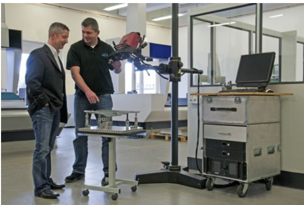
Abb. 2: Die Umstellung von taktiler auf optische Messtechnik wurde bei GEDIA mit der Anschaffung eines mobilen ATOS 3D-Scanners für die vollflächige optische 3D-Koordinatenmessung eingeleitet. Die Messdaten können sofort analysiert und direkt mit dem CAD-Datensatz abgeglichen werden. Anhand farbiger Abweichungsdarstellungen zum CAD sind problematische Bereiche leicht zu erkennen, so dass der Herstellungsprozess zielgerichtet verbessert werden kann.
