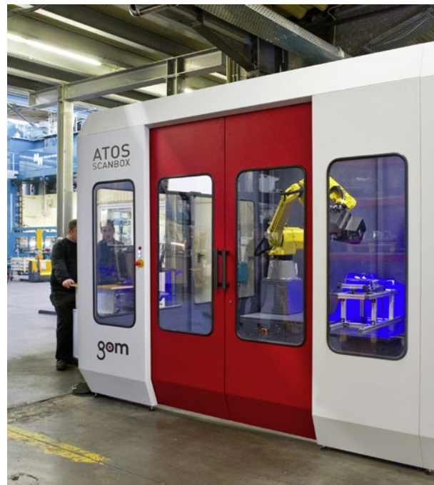
Abb. 5: Die standardisierte ATOS ScanBox beinhaltet ab Werk sämtliche für die vollautomatisierte 3D-Digitalisierung und -Inspektion erforderlichen Elemente. Im Presswerk Attendorf ist es mit Hilfe der ATOS ScanBox gelungen, die Messzeiten im Vergleich zur früheren taktilen Messung um mehr als die Hälfte zu verkürzen.
