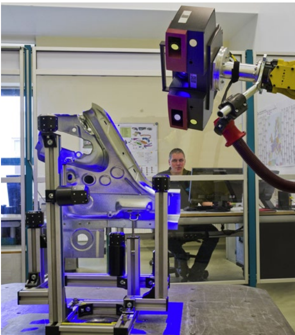
Abb. 4: Die erste automatisierte Lösung bei GEDIA: eine vom Automobilzulieferer selbst konzipierte Projektmesszelle mit integrierter GOM Technik.
