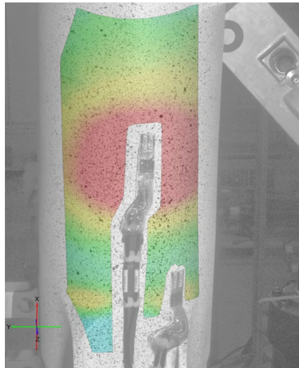
Abb. 2: Sowohl punktuelle als auch flächenhafte dreidimensionale Verschiebungen und Dehnungen werden erfasst.
