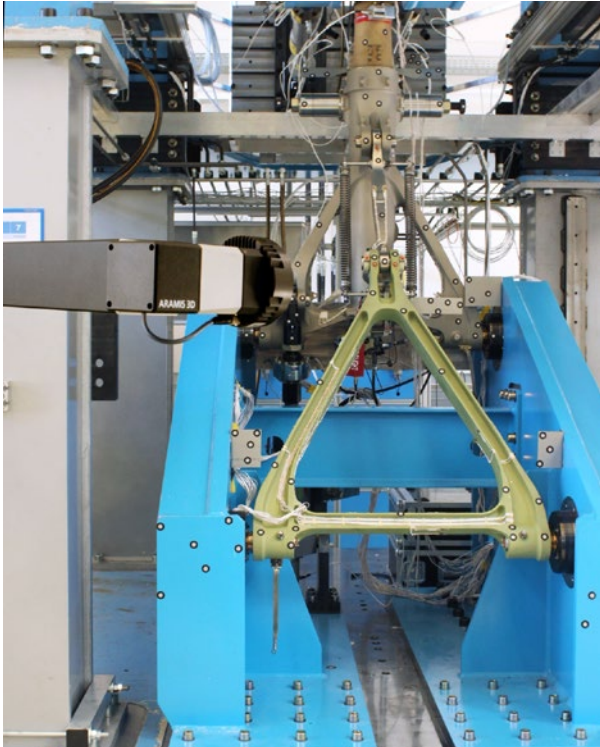
Abb. 3: ARAMIS lässt sich leicht in den Versuchsaufbau integrieren. Die Inspektionpunkte werden über Messmarken identifiziert.
