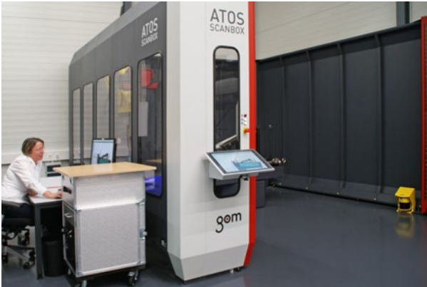
Abb. 4: Allgaier Automotive setzt die ATOS ScanBox 6130 ein, in der auch große Karosserieteile durch ihren breiten Zugang einfach beladen und gemessen werden können.
