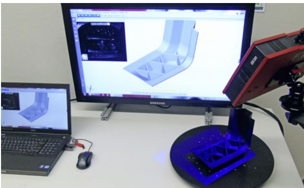
Abb. 5: Soll gegen Ist: Der optische 3D-Scanner ATOS digitalisiert das Demobauteil „Chemnitzer Haken“, ein U-Profil mit Rippenstruktur. Die Software stellt die Abweichungen u. a. in Falschfarben dar (© TU Chemnitz)
