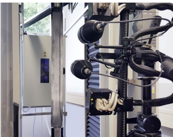
Abb. 3: Der Dachspiegel im Belastungstest. Das Messsystem ARAMIS überwacht den Versuch und liefert sowohl flächenhafte als auch punktuelle Messdaten (© TU Chemnitz)
